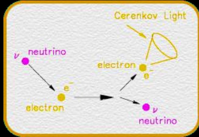
**Effet Tcherenkov** : émission de lumière dans un milieu, causée par le passage d'électrons traversant SK à une vitesse supérieure à celle de la lumière
