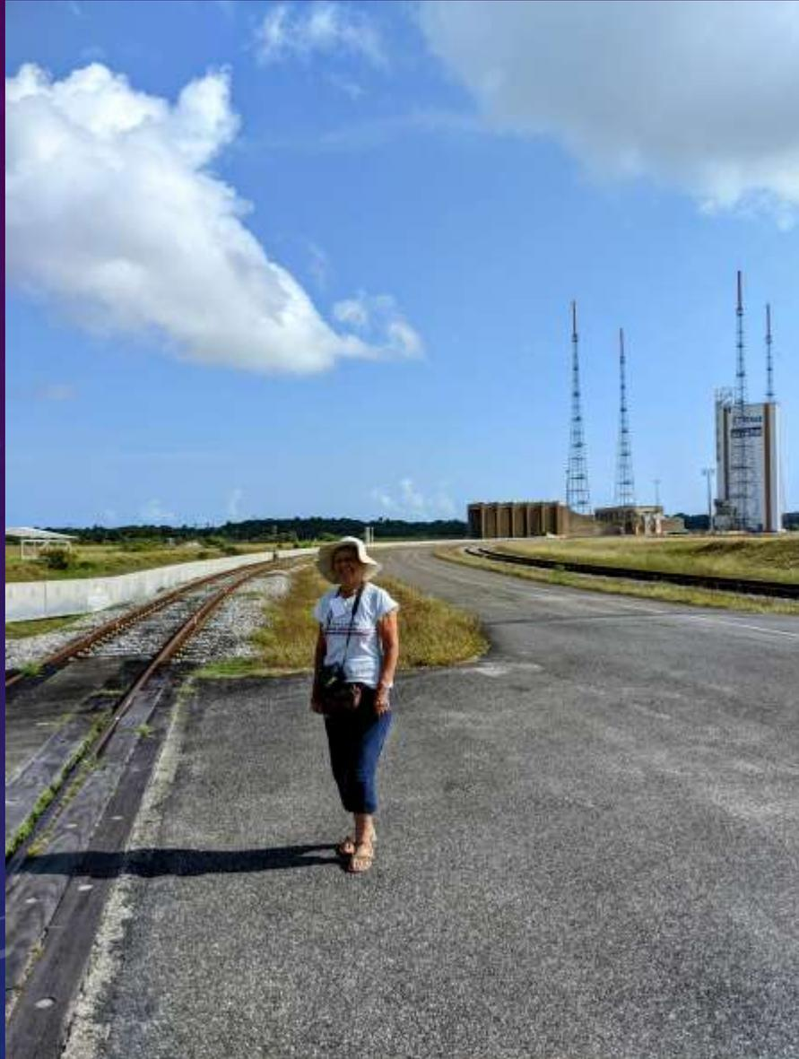
En arrière plan à droite plateforme de lancement d'Ariane 5 (désaffectée). On voit ,de part et d'autre ,les rails de la plate forme qui transportait (très lentement) la fusée Ariane, assemblée verticalement, debout ,de son hangar d'assemblage au site de lancement.
