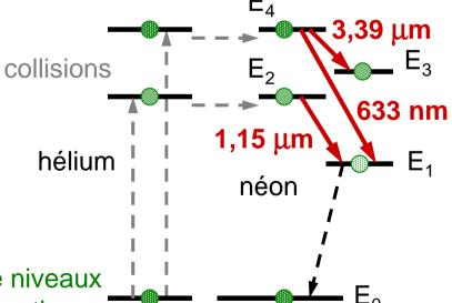
Qu'il soit optique ou non, le pompage à quatre niveaux est plus efficace et permet de fonctionner en continu
