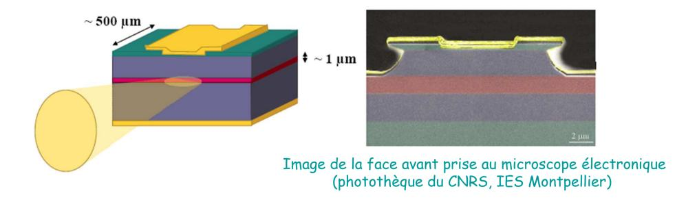
en rouge : la couche active émettrice les deux faces (avant et arrière) forment les miroirs de la cavité en jaune (en haut et en bas) : les contacts électriques
