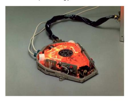
Effet Sagnac : si le référentiel du laser est en rotation à  $\Omega$ , les deux ondes se contre-propageant dans le laser ont des fréquences différentes.
