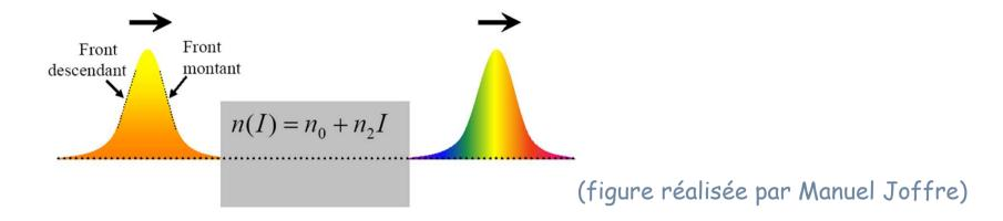
Pendant le front montant de l'impulsion, l'éclairement du milieu augmente. L'épaisseur optique du milieu augmente ce qui retarde la phase : il en résulte un glissement vers le rouge du début de l'impulsion
