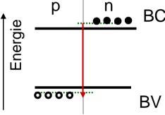
L'application d'un courant électrique contraint les électrons à migrer du matériau de type n vers le matériau de type p et les trous du matériau de type p au matériau de type n semi-conducteur
