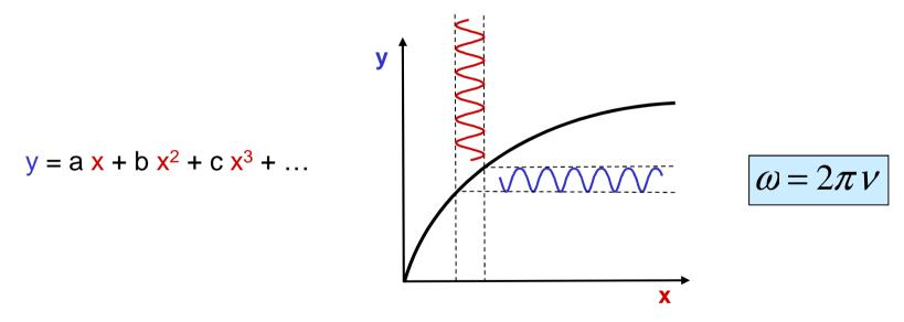
Pour une onde incidente à  $\omega$ , la réponse de l'atome n'est pas sinusoïdale et contient des fréquences harmoniques à  $2\omega$ ,  $3\omega$ , etc.
