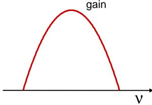
L'oscillation laser ne peut démarrer que si le gain est supérieur aux pertes
