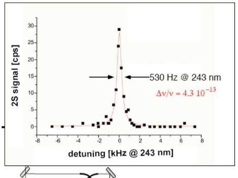
La fréquence de la transition 1S-2S de l'atome d'hydrogène a été mesurée avec une précision de 4.2 x 10<sup>-15</sup>
