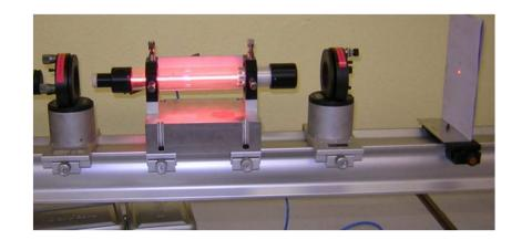
Le laser fonctionne : on voit une tache lumineuse sur le papier ou sur le mur Décharge électrique dans un tube capillaire
