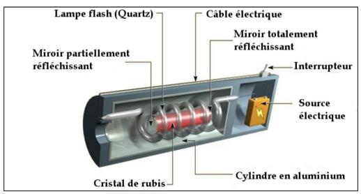
Le cylindre de rubis(\*) est entouré d'un serpentin de verre dans lequel on allume une décharge électrique
