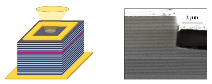
Image en coupe du laser prise au microscope électronique (CNRS, LPN Marcoussis)
