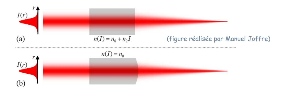
Le faisceau est focalisé par le milieu amplificateur
