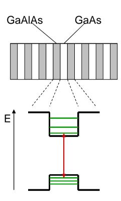
Structure à multi-puits quantiques
