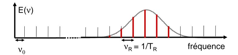
On compare la fréquence à mesurer à celle d'une des dents du peigne de fréquences
