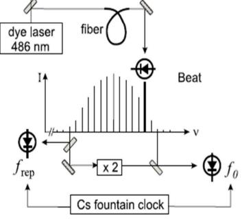
Les peignes de fréquences permettent de synthétiser des fréquences optiques et de les comparer à un niveau de précision de 10<sup>-19</sup>! Science **303**, 1843 (2004)
