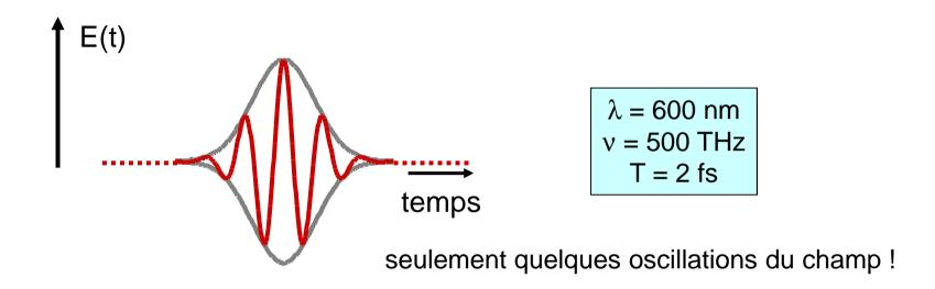
Plus l'impulsion est courte, plus la largeur spectrale du laser doit être grande
