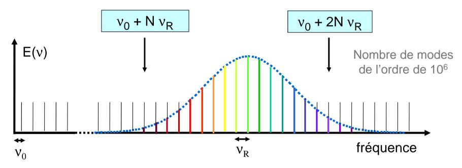
En comparant la fréquence du premier pic doublée à celle du second pic, on obtient  $v_0$   $v_R$  est mesuré directement par comparaison avec l'horloge à Cs
