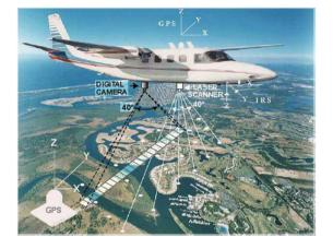
Il est utilisé pour la cartographie et la géodésie mesure de distance
