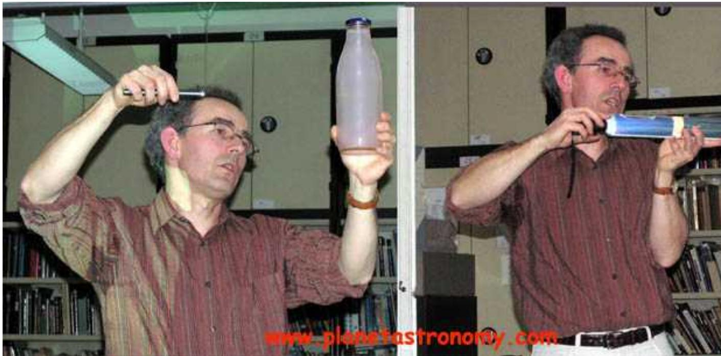
Un faisceau de lumière verte traverse la bouteille pleine de fumée et il est visible. Un faisceau de lumière blanche traversant un liquide contenant de très fines particules, est plus atténué et ses radiations bleues sont plus absorbées que les rouges.
