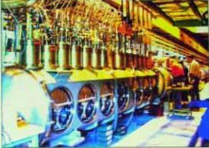
Des milliers d'aimants supraconducteurs pour guider les protons dans un tunnel circulaire
