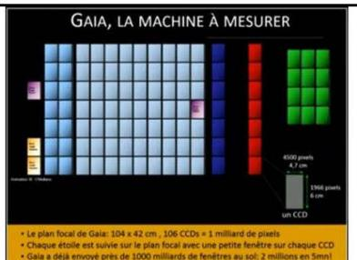
Le e plan focal est le plus important jamais développé, avec 106 capteurs CCD, près de 1 Gigapixels et des dimensions 1m par 0,4m
